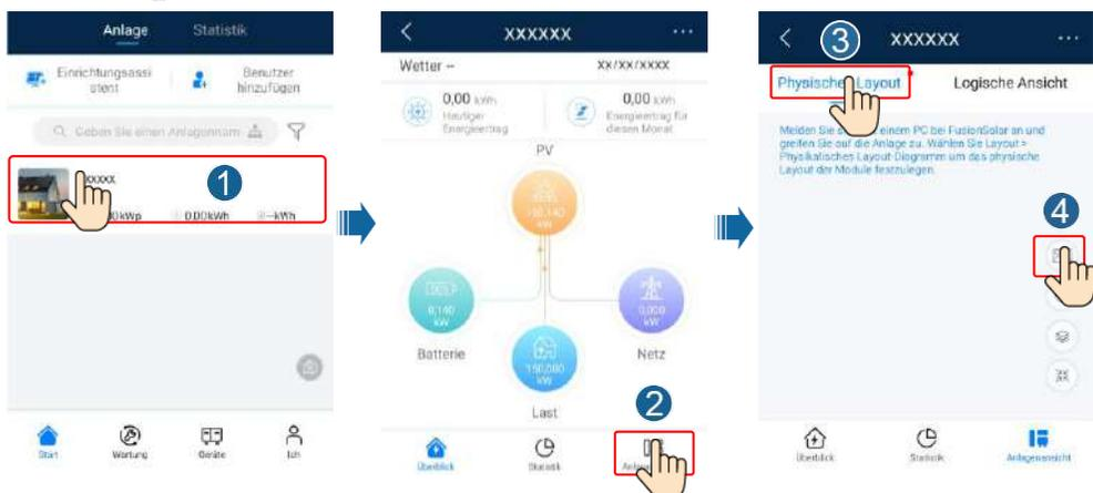
2. Melden Sie sich bei <https://intl.fusionsolar.huawei.com>, um auf die Web-UI des FusionSolar Smart PV-Managementsystems zuzugreifen. Klicken Sie auf der **Start** auf den Anlagennamen, um die Anlagenseite aufzurufen. Wählen Sie **Layout**. Wählen Sie **Layout erstellen** und erstellen Sie nach Aufforderung eine physische Layoutvorlage. Sie können ein Layout des physischen Standorts auch manuell erstellen.
