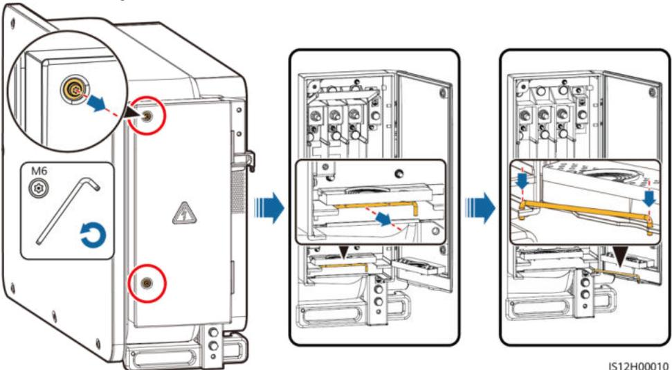
3. Entfernen Sie die Zubehörteile und legen Sie sie beiseite.
