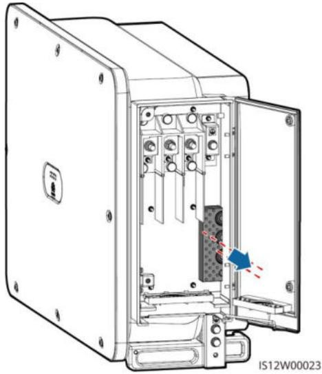
4. Wählen Sie eine geeignete Kabeldurchführung an der Leiste für den Typ des AC-Ausgangsstromkabels.
