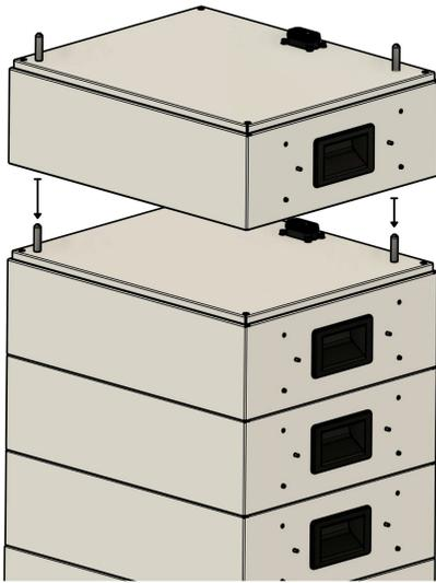
6. Alle restlichen FENECON Home 20&30 - Batteriemodule auf die gleiche Weise montieren.
